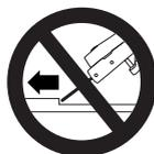
Ne pas utiliser la machine pour un meulage de côté ou un dégrossissage.
