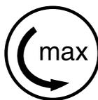
La vitesse de rotation maximale admissible pour le disque à découper doit être égale ou supérieure au régime maximal de la broche de la découpeuse à disque ! – Voir chapitre « Caractéristiques techniques ».
