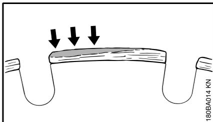
Par arêtes rapportées on entend le dépôt gris clair qui se forme en haut des segments diamantés. Ce dépôt engorge les diamants et les segments perdent leur mordant.
