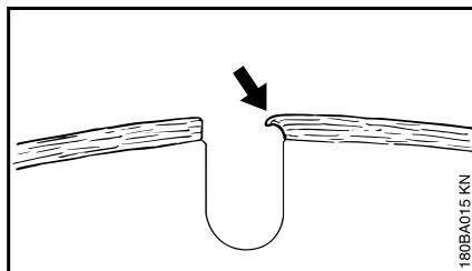
Si l'on poursuit le travail avec des segments engorgés, manquant de mordant, ces segments peuvent se ramollir sous l'effet de la forte chaleur dégagée – la solidité du corps du disque surchauffé se dégrade – cela peut engendrer des contraintes nettement reconnaissables aux mouvements oscillants du disque. Ne pas poursuivre le travail avec ce disque – **risque d'accident !**
