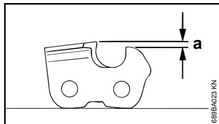
El limitador de profundidad determina el grado de penetración en la madera, y con ello, el grosor de las virutas.
