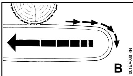
Se, durante o corte com o lado superior da guia – corte de revés – a corrente emperrar ou tocar num objeto sólido na madeira, a motosserra pode ser puxada para trás na direção do utilizador **para evitar isto:**
