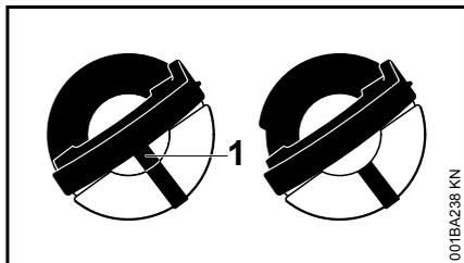
à esquerda: A parte inferior da tampa do depósito é torcida – a marcação no interior (1) está em alinhamento com a marcação exterior
