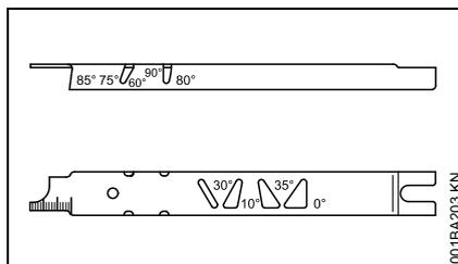
Plantilla de limado STIHL (accesorio especial, véase la tabla "Herramientas de afilar") – una herramienta universal para el control del ángulo de afilado y el de la cara de ataque, de la distancia del limitador de profundidad, la longitud de
