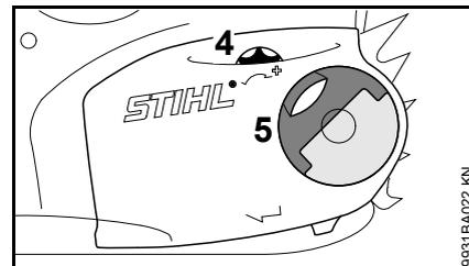
Al aplicar la tapa del piñón de cadena, tienen que engranar entre sí los dientes de la rueda tensora y los del disco tensor; si es necesario,
