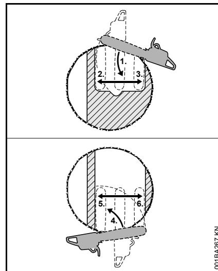
Executar este corte de abate quando o diâmetro do tronco é maior que o comprimento de corte da moto-serra.
