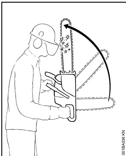
Durante um ressalto (kickback), a serra é lançada de forma repentina e descontrolada na direção do utilizador.
