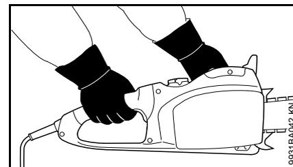
**Segurar** a moto-serra sempre com as duas mãos: A mão direita no cabo da mão traseiro – também para os canchotos. Abranger bem o cabo de manejo e o cabo da mão com os polegares para uma condução segura.
