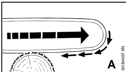
Se, durante o corte com o lado inferior da guia – corte dianteiro – a corrente emperrar ou tocar num objeto sólido na madeira, a motosserra pode ser puxada aos solavancos em direção do tronco – **para evitar, colocar o encosto de garras sempre em segurança.**
