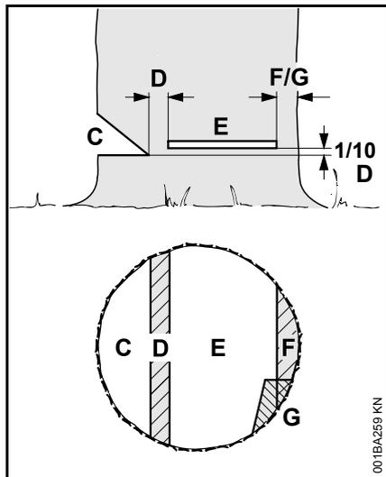
O **entalhe direccional** (C) determina a direcção de abate.
