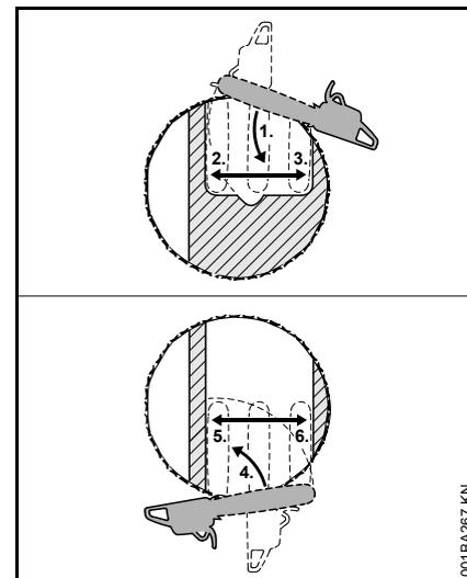
Realizar este corte de talado si el diámetro del tronco es más grande que la longitud de corte de la motosierra.
