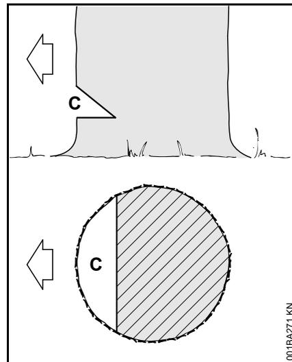
O entalhe direccional (C) determina a direção de abate.
