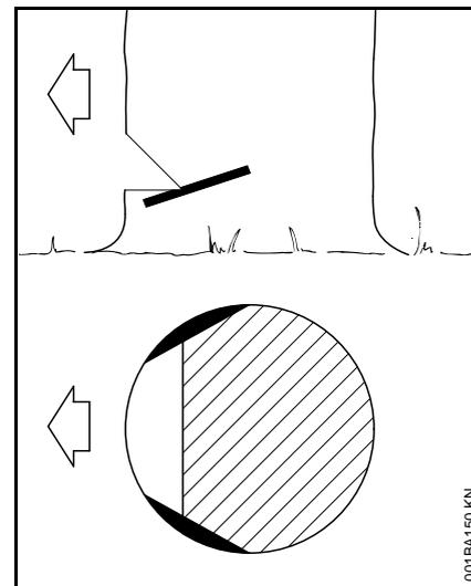
Os cortes de cunha evitam em madeiras de fibra longa que o alburno seja rachado durante a queda do tronco – cortar nos dois lados do tronco na altura da superfície do entalhe direccional aprox. 1/10 do diâmetro do tronco – nos troncos mais grossos no máximo até à largura da guia.
