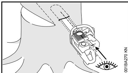
Si es posible, emplear una marca para el corte de punta. La marca para el corte de punta y el lado superior o el inferior de la espada son paralelos.
