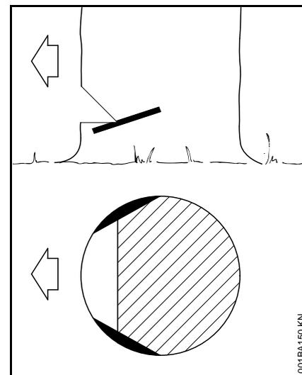
Los cortes de albuja impiden que se desgarre la albuja al talar el tronco en maderas de fibras largas – cortar en ambos lados del tronco a la altura de la base de la muesca de caída hasta aprox. 1/10 del diámetro del tronco – al tratarse de troncos de cierto grosor, cortar hasta el ancho de la espada, como máximo.
