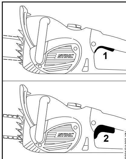
El freno de funcionamiento por inercia hace que se pare la cadena cuando se suelta por completo la palanca de mando.
