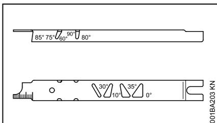
Calibrador de limas STIHL (acessório especial, vide a tabela "Ferramentas para a afiação") – uma ferramenta universal para controlar o ângulo de afiação e o ângulo de corte, a distância dos limitadores de profundidade, o
