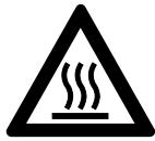
El engranaje se calienta durante el trabajo. No tocar la caja del engranaje – **¡peligro de quemaduras!**
