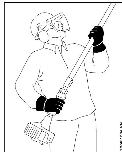
Pour pouvoir manier la machine en toute sécurité, toujours la tenir fermement à **deux mains** – la poignée de commande de la main droite, le tube de la main gauche – ceci est également valable
