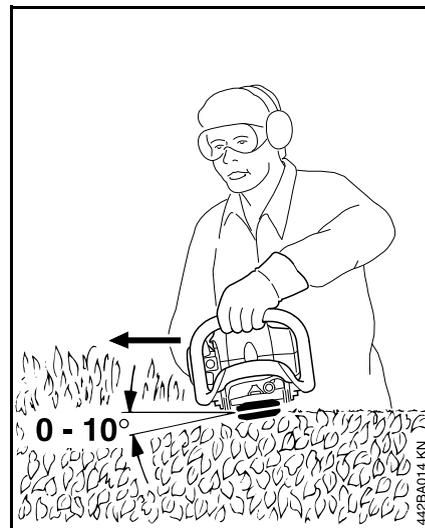
Poziționați cuțitele tăietoare într-un unghi de 0° până la 10°, însă ghidați-le pe orizontală.
