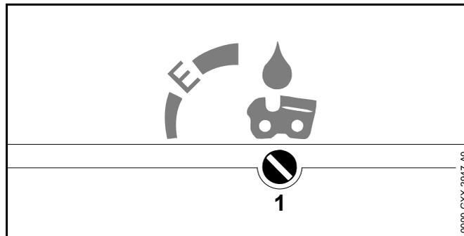
Le débit d'huile de chaîne convient à la plupart des applications lorsque la vis de réglage du débit d'huile (1) est en position **E** (Ematic).
