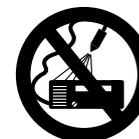
Não molhar a lavadora ou outros equipamentos elétricos com o jato de alta pressão ou com a mangueira de água. **Perigo de curto-circuito!**
