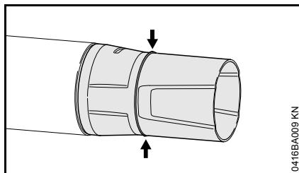
Prednji deo mlaznice se u toku rada troši zbog trenja sa tlom. Mlaznica spada u potrošni materijal koji se kod dosezanja oznake istrošenosti mora zameniti.
