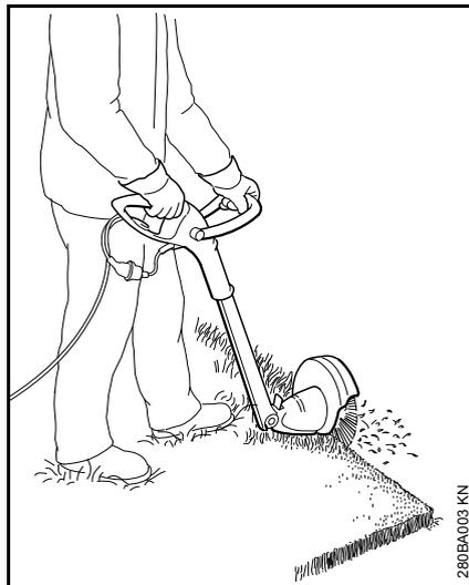
A máquina pode ser transformada facilmente em cortadora de cantos (veja "Transformar a máquina em cortadora de cantos").
