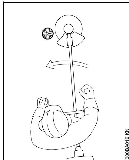
Las sierras circulares son adecuadas para recortar matorrales y cortar árboles pequeños de hasta 4 cm (1-1/2 pulg) de diámetro. No intente cortar árboles cuyo diámetro sea mayor, puesto que la cuchilla puede atorarse o tirar de la orilladora / cortadora de matorrales repentinamente hacia adelante. Esto puede dañar la cuchilla o causar la pérdida de control de la herramienta motorizada, lo cual puede resultar en lesiones personales graves. Utilice una motosierra para estos tipos de trabajos.
