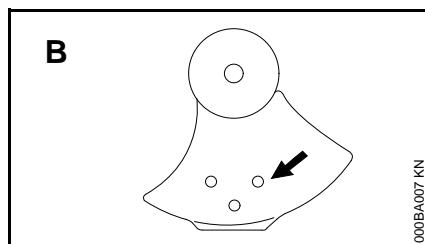
Las flechas en el deflecto (A) y en el tope limitador (B) (visto desde el lado inferior) muestran el sentido correcto de rotación del accesorio de corte. Sin embargo, al verlo de arriba, el accesorio de corte gira en sentido contrahorario.
