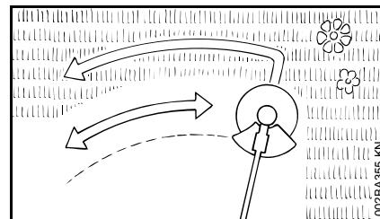
Todos los tipos de pasto y malezas se pueden cortar fácilmente con la cuchilla de cortar pasto. Para ello, la herramienta motorizada se mueve en forma de arco, como si fuera una guadaña.
