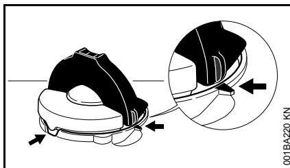
las marcas de posición en la empuñadura de la tapa y en la boca del tanque. Utilice la empuñadura para oprimir la tapa firmemente hacia abajo mientras la gira en sentido horario hasta que tope (aprox. un cuarto de vuelta).
