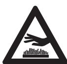
Algunas herramientas motorizadas STIHL están equipadas con un convertidor catalítico, el que está diseñado para reducir las emisiones de escape del motor mediante un proceso químico en el silenciador. Debido a este proceso, el silenciador no se enfriá tan rápidamente como los del tipo convencional cuando el motor regresa a marcha en vacío o es apagado. Para reducir el riesgo de incendio y de lesiones por quemadura, es necesario respetar las siguientes medidas de seguridad específicas.
