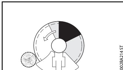
Antes de iniciar el corte, acelere el motor a su velocidad máxima. Efectúe el corte aplicando presión uniforme. STIHL recomienda aplicar la sierra circular por el lado derecho del árbol, usando la zona no sombreada de la cuchilla, tal como se muestra en la ilustración de arriba.
