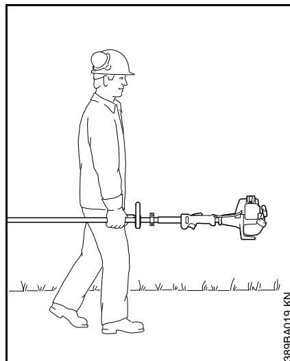
Puede acarrearse solamente en posición horizontal. Agarre el eje de una manera que mantenga la máquina equilibrada horizontalmente. Mantenga el silenciador caliente lejos de su cuerpo y el accesorio de corte detrás de usted.
