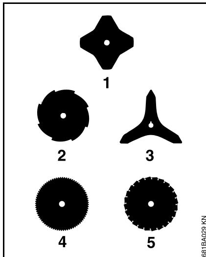
**La faldilla y cuchilla limitadora del hilo no son necesarios para el deflector y las cuchillas para pasto 230-4 (1) y 230-8 (2) ni la cuchilla para matorrales (3) – ver "Montaje del deflector".**
