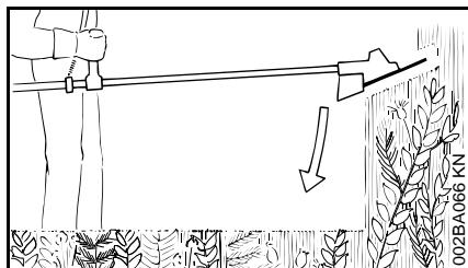
Para cortar plantas y arbustos silvestres, baje la cuchillatoria para matorrales hasta la planta para crear un efecto de picado, pero mantener la herramienta por debajo del nivel de la cintura en todo momento.
