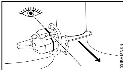
Tato motorová pila je vybavena kácecí lištou na krytu a víku ventilátoru. Použijte tuto kácecí lištu.
