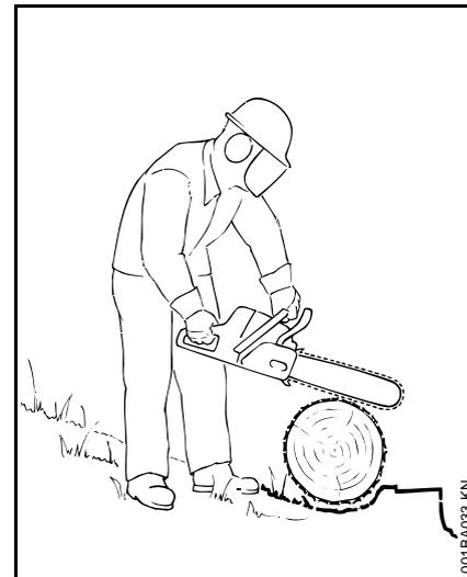
Na svahu stát vždy nad kmenem či pokáceným stromem a nebo vedle něj. Dbát na valící se stromy.
