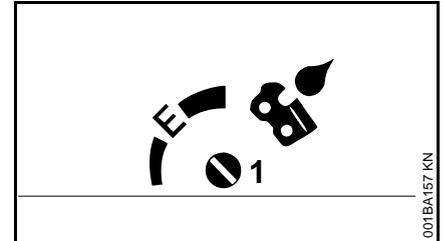
Seřizovacím čepem (1) (na spodní straně stroje) lze podle potřeby regulovat množství dopravovaného oleje.
