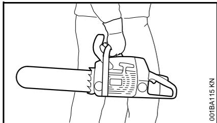
Motorovou pilu nosit jenom za trubkovou rukojeť – s horkým tlumičem výfuku na odvrácené straně od těla, s vodící lištou směřující dozadu. Nikdy se nedotýkat horkých dílů stroje, zejména povrchu tlumiče výfuku – hrozí nebezpečí popálení!
