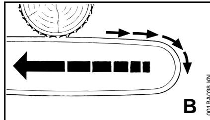
Když se při řezání horní větví lišty – směrem odspodu nahoru – řetěz zasekne či narazí na nějaký pevný předmět ve dřevě, může se motorová pila odrazit zpět směrem k uživateli – **aby se tomu zabránilo:**
