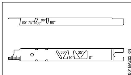
Pilovací měřka STIHL (zvláštní příslušenství, viz tabulka "Náradí pro ostření") – univerzální nástroj ke kontrole úhlu ostření a úhlu čela, vzdálenosti omezovače hloubky, délky zubu, hloubky drážky a pro čištění drážky a vstupních otvorů oleje.
