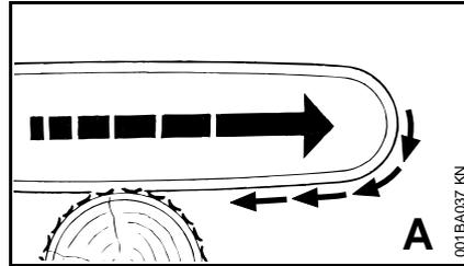
Když se při řezání spodní větví lišty – směrem dolů – pilový řetěz zasekne či narazí na nějaký pevný předmět ve dřevě, může být motorová pila rázem vtažena dopředu ke kmenu – **k zabránění této situace vždy bezpečně nasadit ozubený doraz.**
