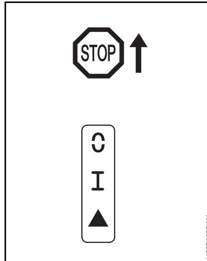
**STOP** resp. 0 – pro vypnutí zapalování je třeba kombinovanou ovládací páčku zatlačit směrem ke **STOP** resp. 0. Po uvolnění kombinovaná ovládací páčka odpruží zpět do provozní polohy **I**.
