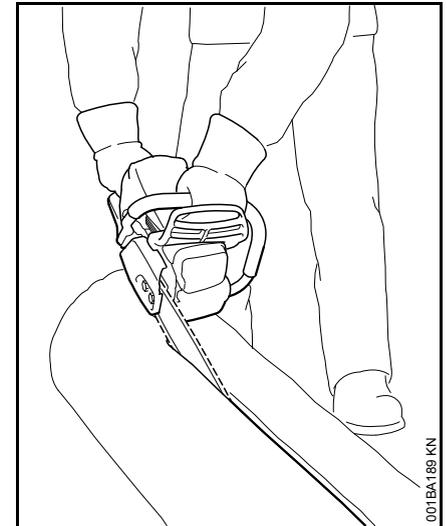
Řezná technika bez použití ozubeného dorazu – zde hrozí nebezpečí vtažení pily – vodící lištu nasadit pokud možno v plochém úhlu – práci provádět obzvláště opatrně – **hrozí zvýšené nebezpečí zpětného rázu!**
