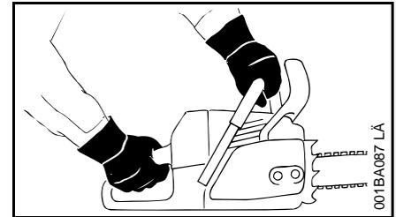
Motorovou pilu držet při práci vždy **oběma rukama**: pravá ruka je na zadní rukojeti – to platí i pro leváky. Za účelem bezpečného vedení pevně obemknout palci jak trubkovou rukojeť, tak i ovládací rukojeť.
