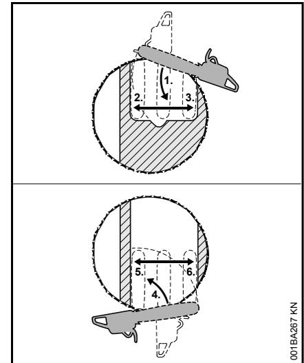
Tento hlavní řez provádějte, je-li průměr kmene větší než řezná délka motorové pily.
