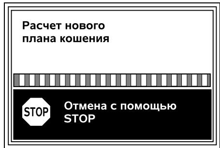
Рассчитывается новый план кошения. С помощью красной кнопки STOP сверху устройства этот процесс может быть прерван.
