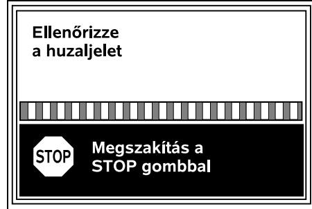
A huzaljelek ellenőrzése több percig is tarthat. A gép felső részén lévő piros STOP gomb segítségével a párosítás megszakítható, ilyenkor a folyamat a telepítési varázsló előző lépéserére ugrik vissza.
