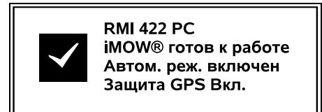
В нижней части индикатора отображаются название робота-газонокосилки (⇒ 10.), текст «iMOW® готов к работе» вместе с приведенным на рисунке символом, статусом автоматического режима (⇒ 11.7) и информацией о защите GPS (⇒ 5.9).
