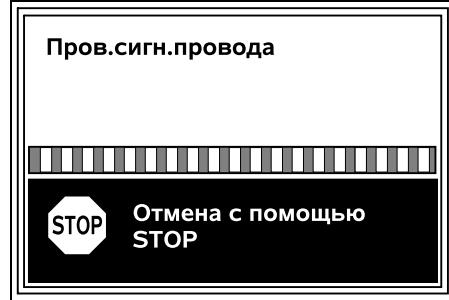
Проверка сигнала провода может занять несколько минут. При нажатии красной кнопки STOP на верхней стороне устройства согласование прерывается, при этом осуществляется переход к предыдущему этапу мастера установки.
