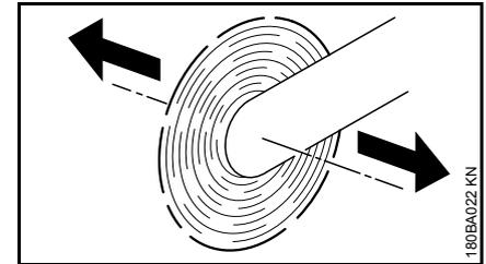
Lorsqu'on déplace une découpeuse dans le sens de la flèche alors que le disque est en rotation, cela engendre une force qui a tendance à faire basculer la machine.
