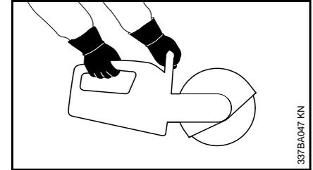
Toujours tenir fermement la machine à **deux mains** : main droite sur la poignée arrière – ceci est également valable pour les gauchers. Pour pouvoir guider la machine en toute sécurité, empoigner fermement la poignée tubulaire et la poignée de commande en les entourant avec les pouces.
