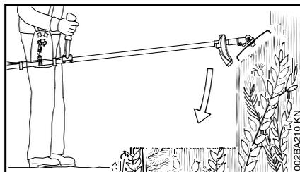
"Mergulhar" a lâmina trituradora no capim e arbustos, que serão triturados. Não erguer a ferramenta de corte acima da cintura.
