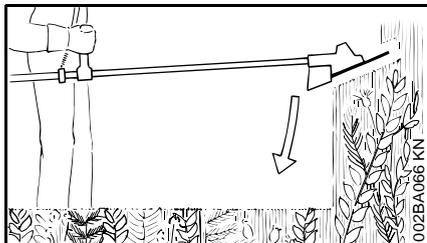
"Mergulhar" a lâmina três pontas no matagal e brenha, que será triturada (cortada em partes). Não erguer a máquina acima da cintura.
