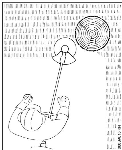
Indicado para corte "macio" e para cortes em volta de árvores e mourões de cerca com capim alto. Menos perigo de ferir a casca da árvore.
