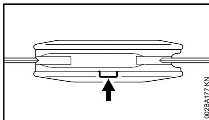
Se uma das marcações do cabeçote de corte PolyCut romper para baixo (seta): não utilizar mais o cabeçote de corte e substituí-lo por um novo! **Perigo de ferimentos** pelas peças lançadas da ferramenta!
