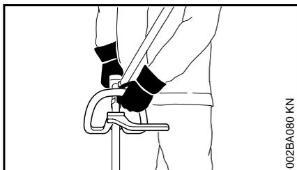
Nas versões com cabo circular e cabo circular com haste (limitadora do passo): mão esquerda no cabo circular e mão direita no cabo de manejo, também para canhotos.
