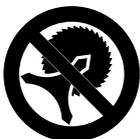
A proteção não pode ser utilizada juntamente com lâminas três pontas, lâminas trituradoras e serras circulares.
