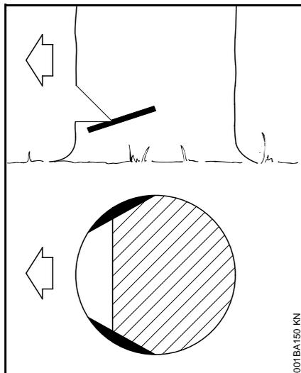
У длиноволокнистой древесины заболонные резы предотвращают разрыв заболони при падении ствола, – запиливание производите с обеих сторон ствола на уровне основания подпила на глубину приблизительно 1/10 диаметра ствола, – у толстых стволов максимально на ширину направляющей шины.
