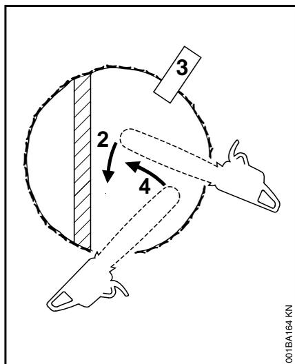
2. При переходе к следующему резу направляющая шина должна находиться полностью в резе, во избежание неровного основного пропила, после этого установите снова зубчатый упор и т.д.
