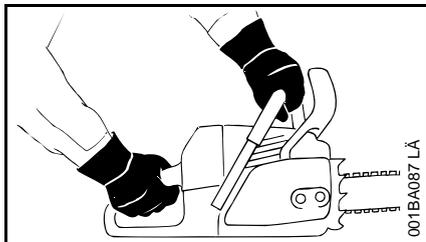
Sujetar la motosierra siempre **con ambas manos**: la mano derecha, en la empuñadura de mando trasera – también los zurdos. Para guiarla de forma segura, asir firmemente el asidero tubular y la empuñadura con los pulgares.
